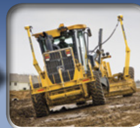
GCS900 Sistema de Control de Cota
