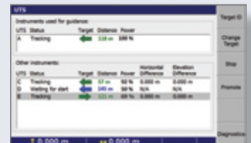
Trimble Cambio Rápido, le permite seleccionar instantáneamente la estación total que le guiará
